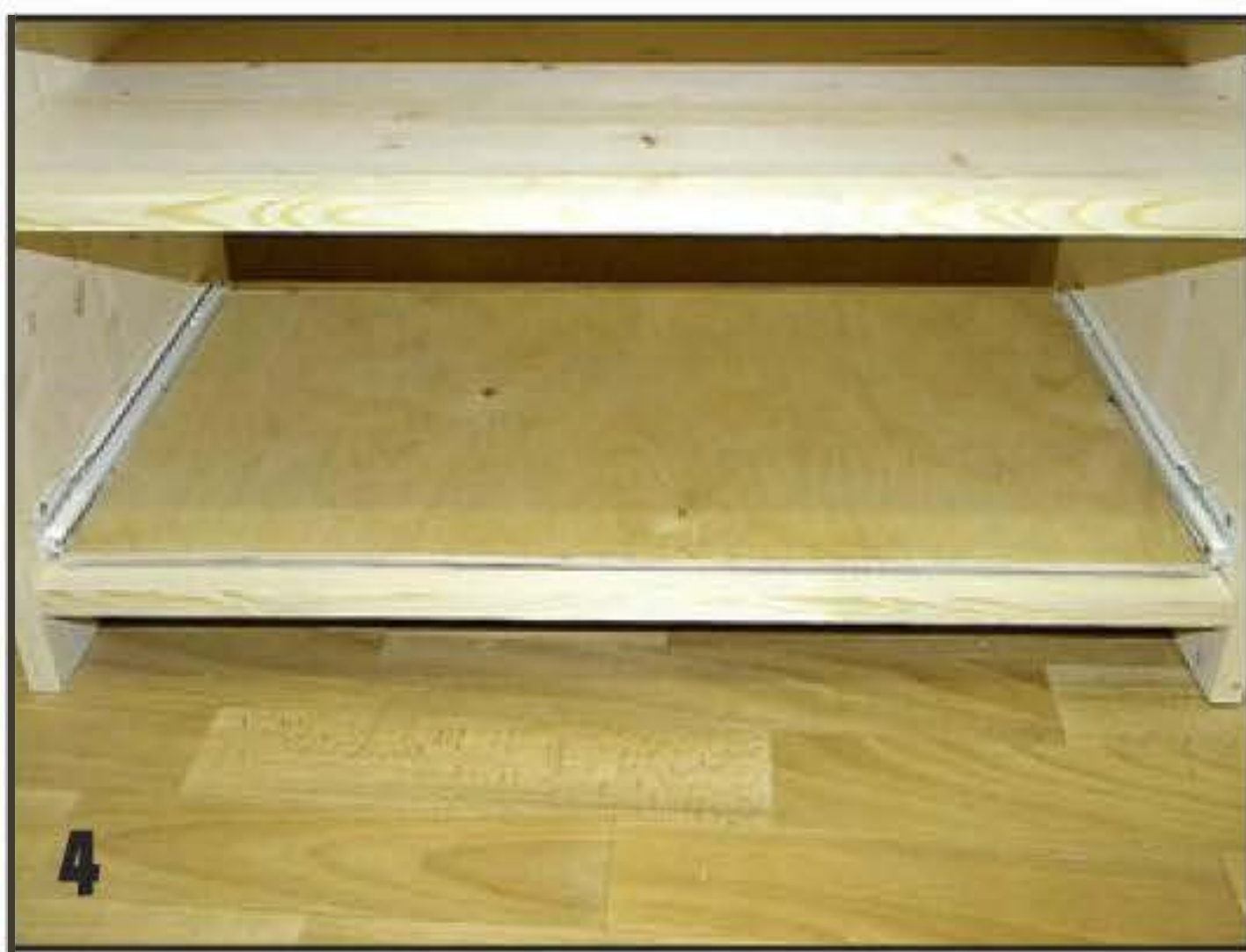
4 Размеры дна ящика соответствуют длине подвижных планок выдвижного механизма и расстоянию между ними.
