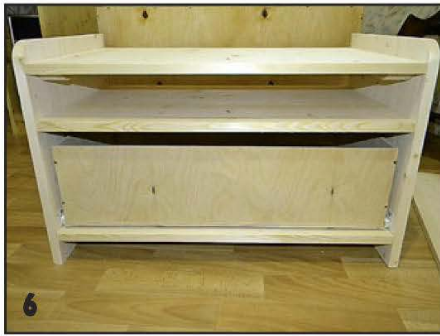
6 Чтобы убедиться, что все детали подходят друг к другу, была выполнена предварительная сборка тумбочки.
