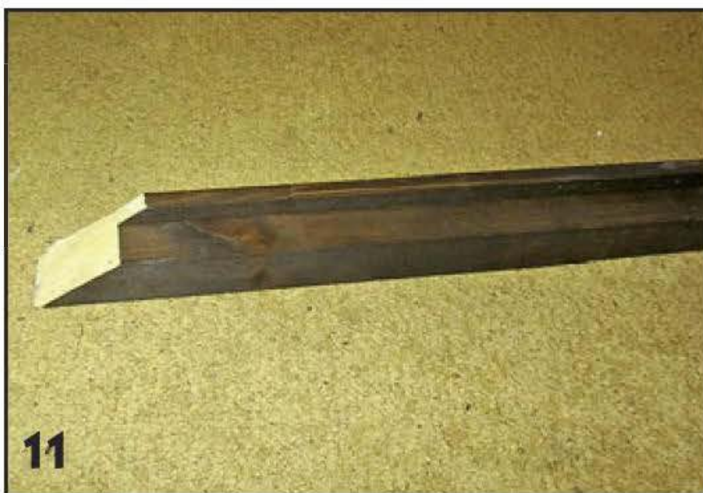
Для формирования фальца к одной из кромок заготовок рамы прикрутили брусок меньшего сечения.
