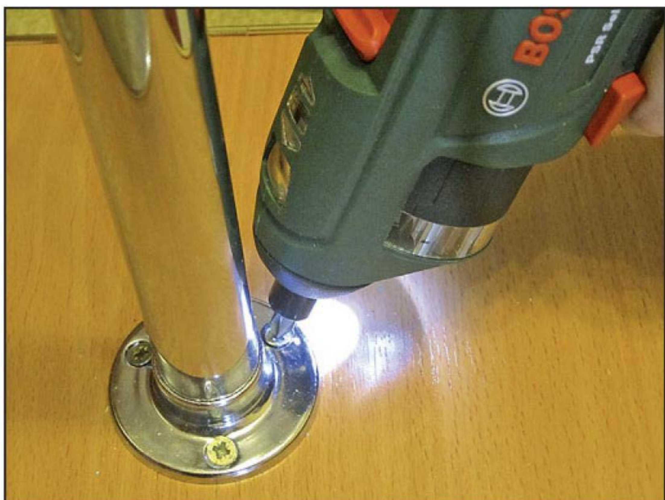
Все полочки, кроме верхней, держатся на фланцах, закреплённых сверху.
