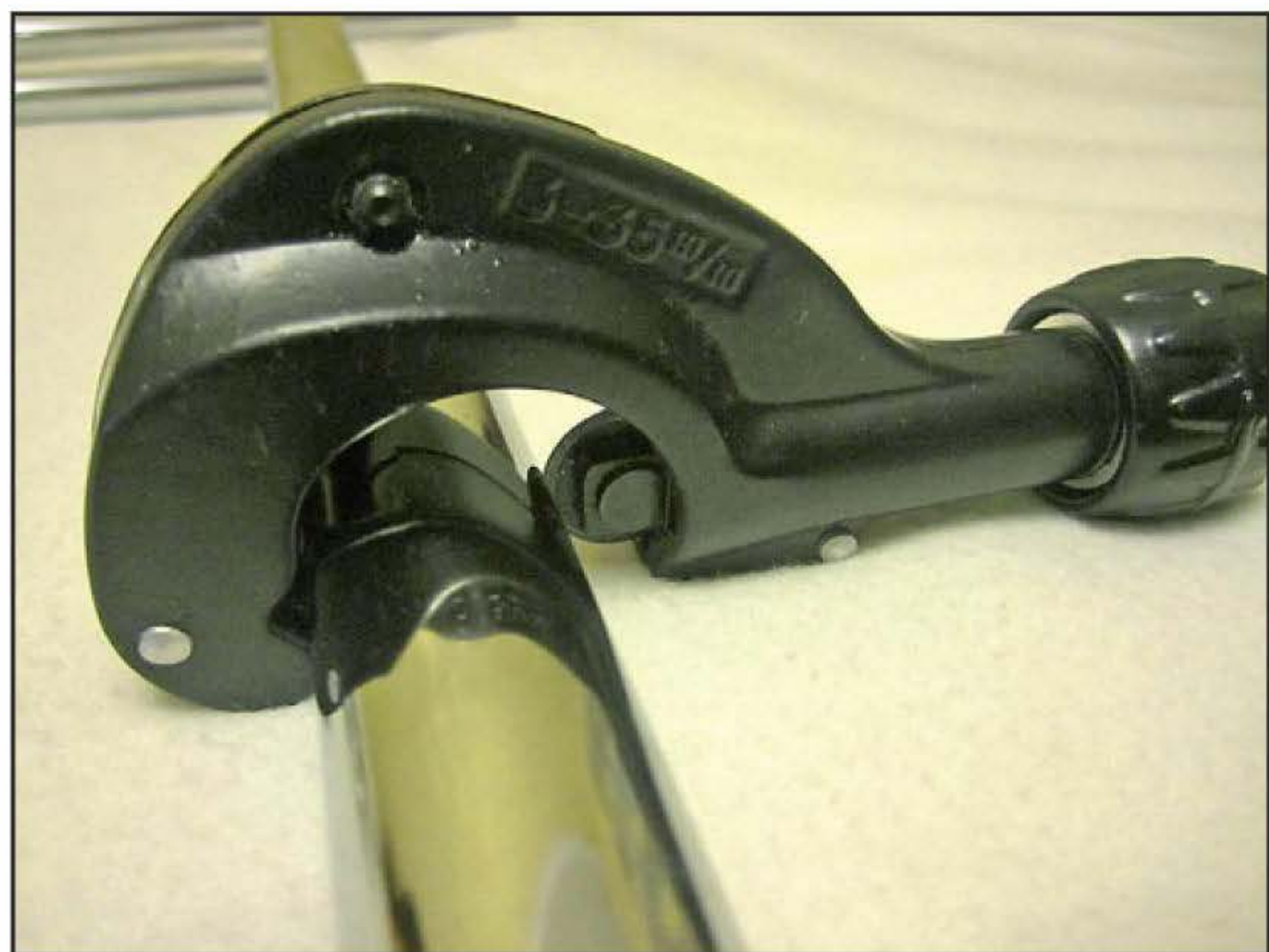
Лёгкий и удобный роликовый труборез DSZH — отличный помощник в работе. Прочный режущий диск позволяет раскраивать трубы не только из меди, но и из других металлов.
