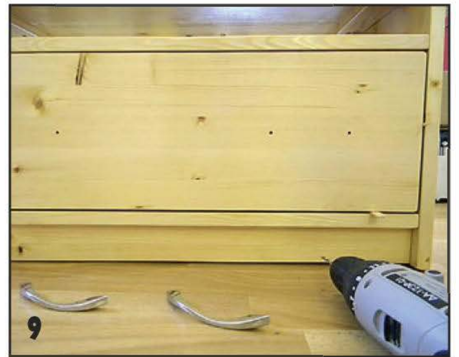
9 При креплении лицевой панели к стенке ящика фиксировал её в проёме щепками.
