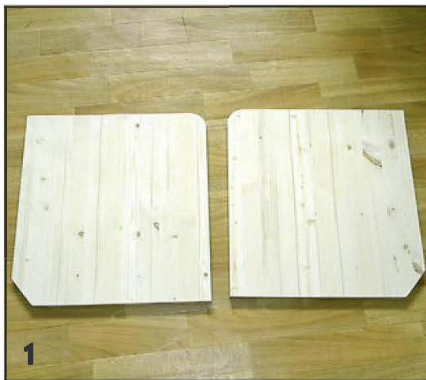
На заготовках боковин сделаны вырезы под плинтус, а передние верхние углы — скруглены.
