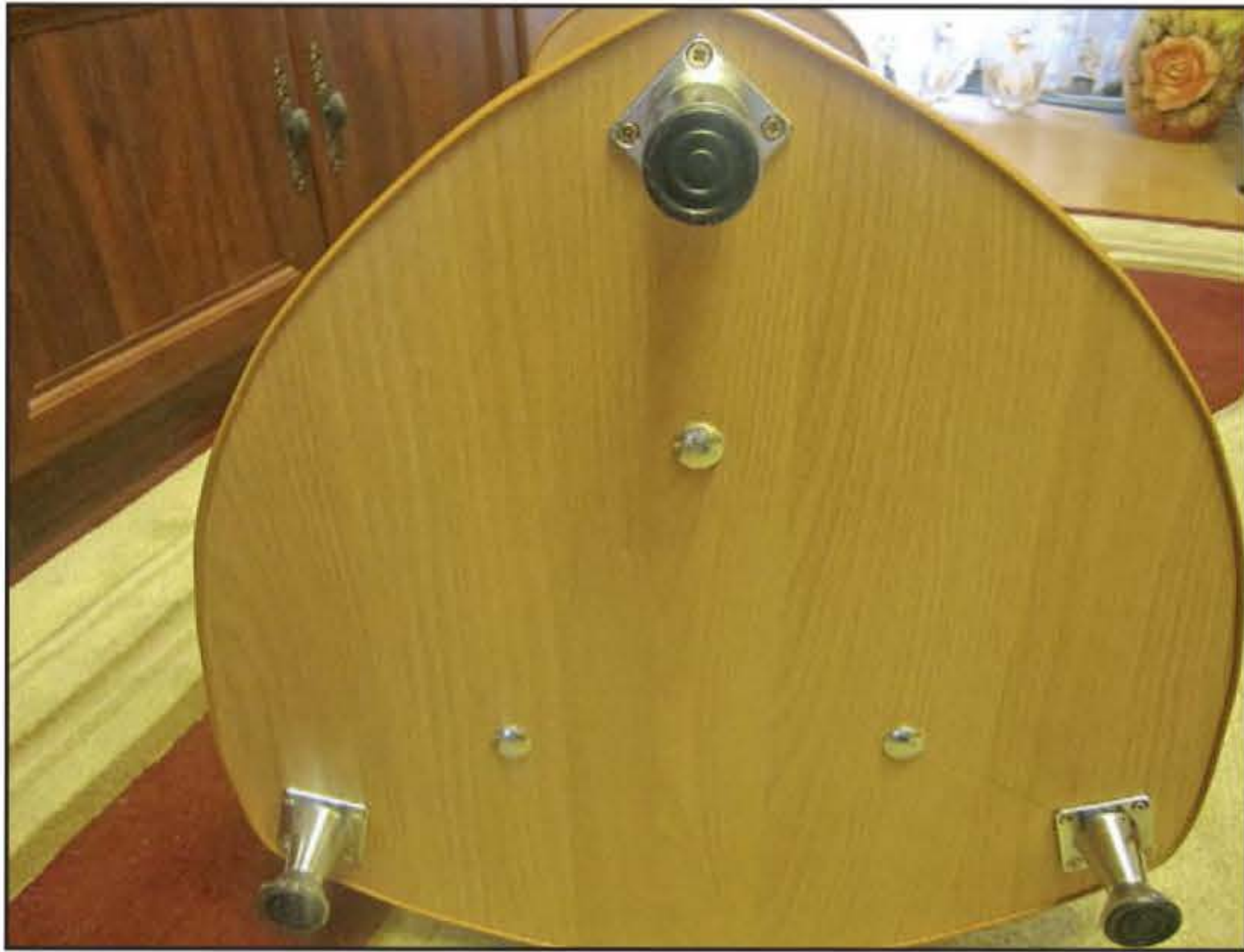
Этажерка будет стоять на трёх мебельных опорах. Здесь видны головки мебельных болтов, которыми закреплены стойки.
